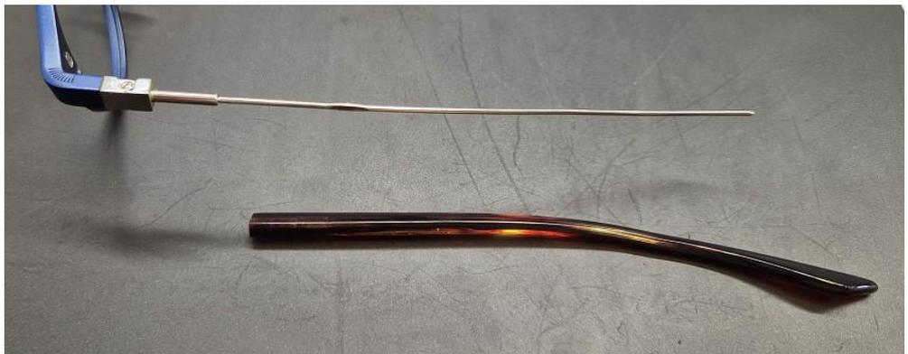
Ajoutez 2mm à la mesure du raccourcissement et coupez l'extrémité de l'armature.
