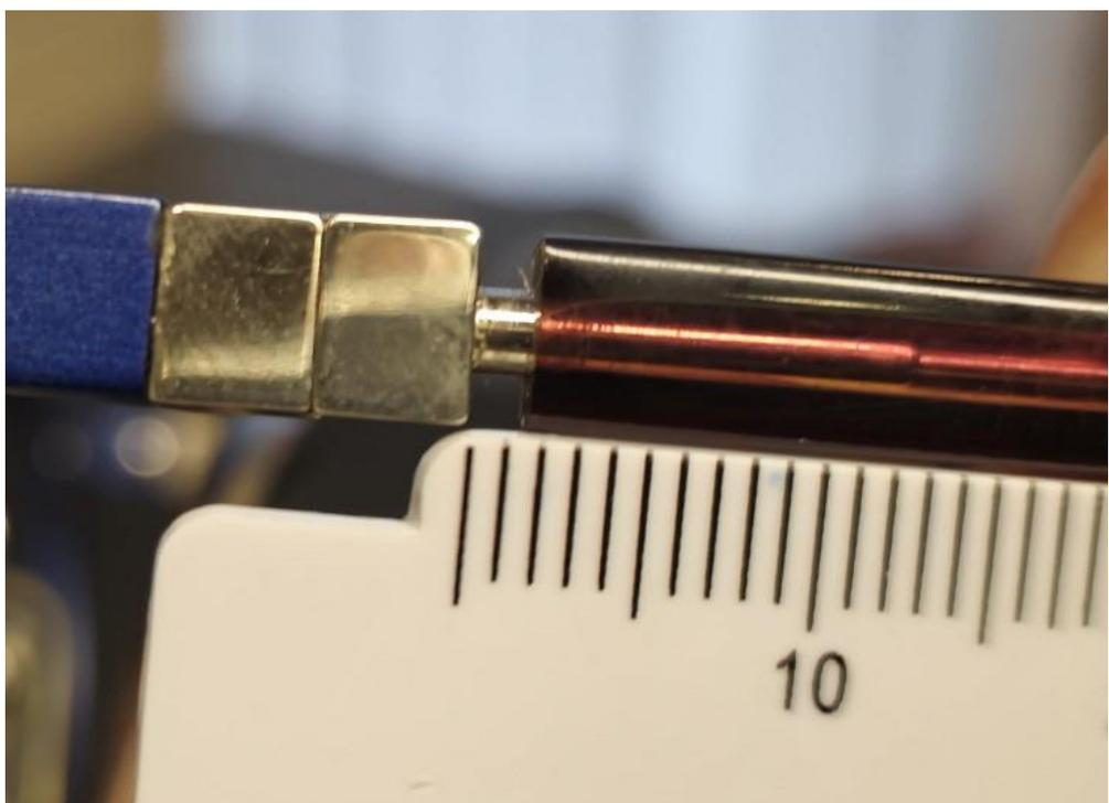
Chauffez et redressez la courbure de l'oreille. Retirez le manchon de l'armature de la branche.
