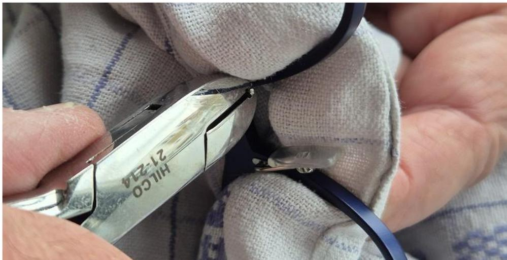
Si c'est une soudure froide et que le bras de la plaquette manque, maintenez une prise ferme et appliquez une pression tout en dévissant la vis T3. Utilisez l'embout de vis T5, placez la pointe de l'embout T5 dans le trou de la vis et soulevez la plaque de base du bras de plaquettes.
